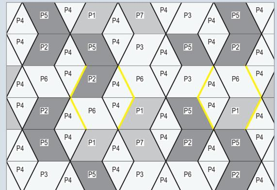
Imagen en primer plano del diseño de los plafones incluidos en el paquete de dibujos ProjectWorks, que muestra cómo se instalan los plafones en todo el espacio del proyecto.
