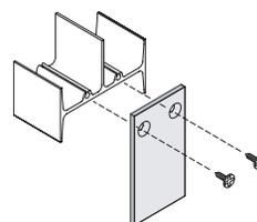
Placa adaptadora para montar una caja de electricidad (AXPAP)
