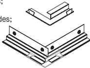
**LFC** - Clip para luminaria - Preacabado White para utilizar en las esquinas de los módulos de luminarias en sistemas de suspensión en T expuesta de 9/16" (Suprafine®, Interlude®, Silhouette®); aumenta el tamaño de la esquina a 15/16", lo que adapta las luminarias diseñadas para el sistema de suspensión de 15/16"; se utiliza cuando las luminarias no están fijadas de forma positiva al sistema de suspensión.
