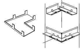
**7863** - Cubierta de esquina exterior - Para moldura angular nominal de 7/8"; encaja sobre la moldura para recortar las esquinas exteriores; patas de 2".
