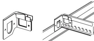
**Clip de junta sísmica - Te principal** - Permite dividir el plafón en un empalme de la Te principal para cumplir el requisito del IBC de que las áreas de cielo acústico de más de 2500 pies cuadrados tengan juntas de separación sísmica. El manguito de expansión ES4 se utiliza para cubrir el espacio de 3/4".
