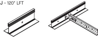
**STAC** - Clip adaptador de Te única - Se utiliza para crear conexiones de Te principal fuera de módulo a Te secundaria que cumplan con los códigos sísmicos y no sísmicos C y D, E, F.
