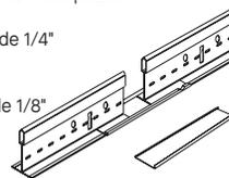
**AXSJ-Axiom® Slip Joint** - Se utiliza para unir dos sistemas de plafones acústicos en instalaciones sísmicas D, E, F. También puede utilizarse para unir dos sistemas de plafón diferentes. Agujeros de alambre de colgante cada 6", comenzando a 3" de cada extremo. AXSJ - 120" LFT
