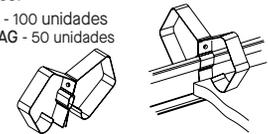
**UHDCA** - Clip de sujeción universal - Se fija al bulbo superior del sistema de suspensión para mantener en su sitio el plafón de orilla cuadrada de 1/16" a 5/8"; ayuda a evitar que el plafón se mueva en las entradas.
