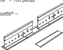
**Junta deslizante AXSJ-Axiom®:** Utilizada para unir dos sistemas de plafones acústicos en instalaciones Sísmicas D, E y F. También puede utilizarse para la unión de dos diferentes sistemas de plafones. Perforaciones alambres para de colganteo a cada 6", iniciando a 3" en cada extremo.
