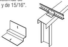
**UTC – Clip de agarre:** Para una conexión ajustada del sistema de suspensión a la canaleta de 1-1/2".
