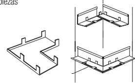
**7863 – Cubierta de Esquina Exterior:** Para moldura nominal en ángulo de 7/8"; broche embutido para equilibrar las esquinas exteriores; patas de 2".
