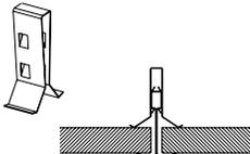
**DW58LT – Clip de transición para panel de yeso:** Facilita la transición del panel de yeso al plafón acústico.
