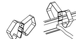
**UHDCA – Clip de retención universal:** Se sujeta al bulbo superior del sistema de suspensión para retener el plafón de orilla cuadrada de 1/16" a 5/8" en su lugar; ayuda a evitar el movimiento del plafón en las entradas.
