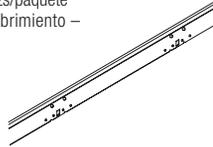
**Clip Espaciador Ajustable para Suspensión:** Utilizado para separar dos Tes principales paralelas a fin de permitir el equipamiento de luminarias, difusores de aire, etc.; permite ajustes de 1/4" con tres diferentes clips. GSC9 Espaciador para Te principal al centro FZGSC9 – 50 pzs 2'1/2" – 8'1/2": 100 pzs
