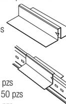
**GA7327 – Adaptador de Suspensión:** Facilita cambios direccionales en las Tes principales Prelude®; el componente de 27" de largo tiene dos diferentes detalles en sus extremos. Uno cuenta con un clip SuperLock™ con un trazo de 3" desde el final, el extremo opuesto tiene un clip XL2 con un detalle de traslape. Esto permite al adaptador conectarse ya sea al final de una Te principal Prelude o conectarse de manera direccional a una Te principal o Te secundaria.
