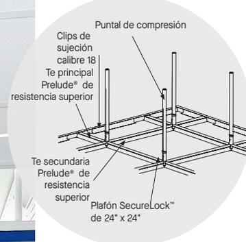
Sistema cielo acústico a prueba de manipulaciones de plafones de acero galvanizado de calibre 18.
