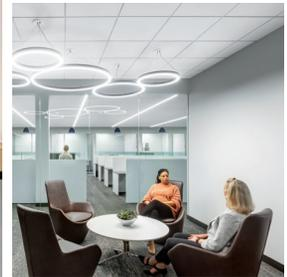
Plafones Tegulares de orilla biselada Ultima con bajo contenido de carbono incorporado con sistema de suspensión Suprafine XL de 9/16"
