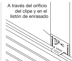
Configuración de plafón con clip 5389 usando listones de enrasado para pared
