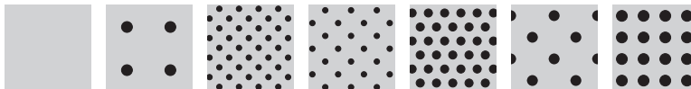
M1 (Sin perforación) M14 (Rg 3205) M15 (Rd 1612) M16 (Rd 1607) M17 (Rv 3223) M18 (Rd 3210) M19 (Rg 3220)
