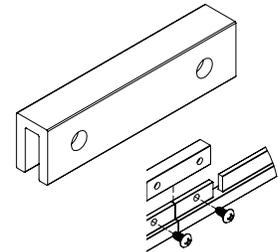
Conector de extremo a extremo de la barra de suspensión
