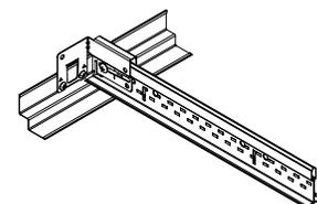
NOTA: BERC se sujeta al sistema de suspensión con 2 tornillos
