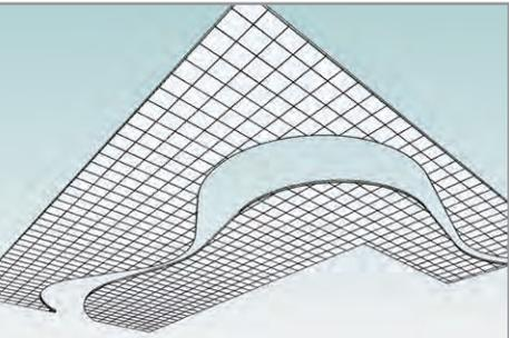
Los modelos Revit incluyen los datos de producto de los plafones, la suspensión y la moldura perimetral
