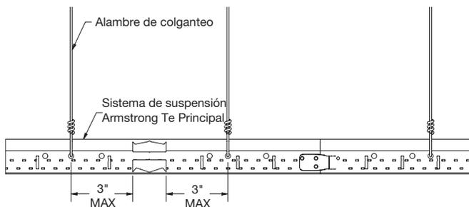
NOTA: Al instalar Tes principales resistentes al fuego, todos los recortes de alivio de expansión de fuego deben tener un alambre de colganteo dentro de tres pulgadas (ASTM C636)
