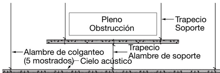
NOTA: Según la Tabla A, un claro de 4 pies de la Te Principal 7301 utilizada como "Soporte del Trapecio" puede soportar una carga puntual en la mitad del claro de 32 libras. Si el "alambre de soporte del trapecio" (Fig. 1) soporta un área de cielo acústico de 16 pies cuadrados (separación de la Te principal de 4 pies x separación del alambre de colganteo de 4 pies), el peso uniforme máximo permitido del cielo acústico es de 2 lb/pie cuadrado (32 lb ÷ 16 pies cuadrados = 2 lb/pie cuadrado)
