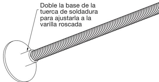
Luego, mueva los plafones en la viga de celosía (uno a cada lado de la red) y alinee los dos plafones entre sí. Con el lado marcado del plafón mirando hacia usted, tome la varilla roscada/tuerca de soldadura doblada y golpee el lado sin tapa a través del plafón, de la brecha de aire entre los plafones y del otro plafón hasta el otro lado.
