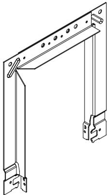
El yugo es un conjunto de dos partes. Las dos mitades son unidas mediante la inserción de tornillos de enmarcación a través de los pequeños orificios que están en la banda superior. Se requieren dos tornillos en cada una de las partes del conjunto del yugo. El yugo se suspende de la estructura superior mediante alambres para colgar galvanizado, recocido, calibre 12 como mínimo o como lo especifiquen los documentos de construcción. Se requiere un alambre de colgar en el centro
