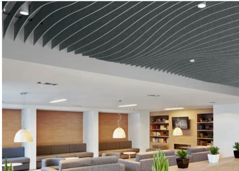
FeltWorks™ Blades Ebbs e Flows com kit de instalação por ganchos com 4" (102mm) de espaçamento entre as lâminas
