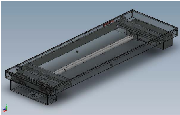
Figure 2 : Image schématique de VidaShield MC montrant les lampes UV internes et la chambre d'irradiation.
