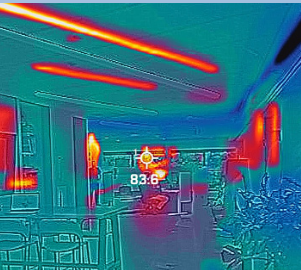
Image thermique montrant les sources de chaleur internes
