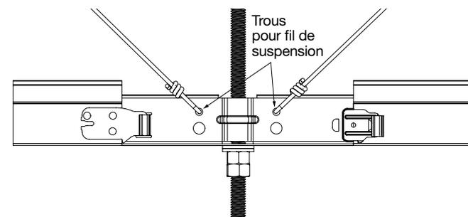
**2.9.** S'il est impossible d'aplomber des tiges à cale filetées, il peut être nécessaire d'utiliser un support trapézoïdal ou un prédormant. Ce support trapézoïdal ou prédormant doit être conçu afin de pouvoir supporter les charges prévues.
