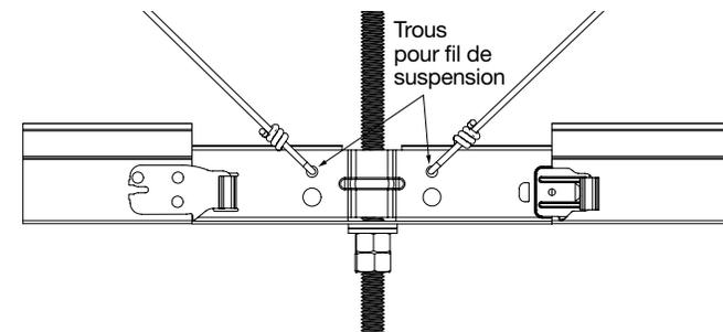
**2.4.** Fixez les tés principaux de chaque côté de l'attach CLP7301 et supportez les tés principaux à moins de 4 pi du raccord avec le longeron CLP7301. Selon la dimension du module, les tés principaux peuvent nécessiter plus d'un support. Lors de la mise à niveau du plafond, la hauteur du longeron CLP7301 peut être ajustée à l'aide d'un écrou situé sous le longeron et en ajoutant un deuxième écrou faisant office de contre-écrou lorsque le longeron CLP7301 est à la hauteur souhaitée.
