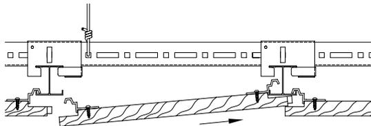
**Étape 2:** Insérer le plus profondément possible le crochet du panneau à une extrémité de la barre en H en aluminium.
