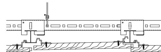
**Étape 3:** Soulever l'extrémité opposée du panneau jusqu'à ce qu'elle touche le dessous de la barre en H en aluminium suivante.
