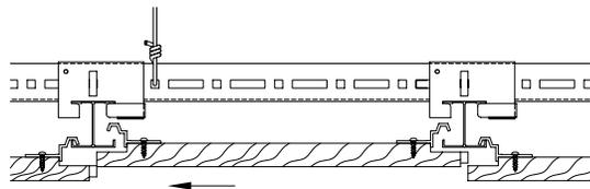
**Étape 4:** Glisser délicatement le panneau vers l'arrière jusqu'à ce que le crochet du panneau soit au-dessus de la barre en H en aluminium.
