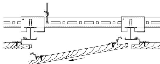
**Étape 4:** Glisser délicatement le panneau vers l'extrémité abaissée jusqu'à ce que le crochet opposé dépasse la barre en H en aluminium et abaisser soigneusement le panneau.
