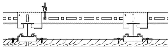
**Étape 5:** Abaisser uniformément le panneau WoodWorks jusqu'à ce que les crochets s'enclenchent dans le profilé en H. Vérifier l'ajustement et l'alignement appropriés des panneaux.
