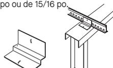
**UTC – Attache de fixation rigide** - pour fixer les systèmes de suspension de manière rigide à des profilés de 1 1/2 po; raccorde sous les conduits de CVC; peut être utilisée pour installer solidement un système de suspension à des solives en bois.
