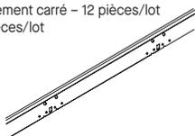
**Attache d'espacement ajustable pour suspension** - Utilisé pour espacer deux tés principaux parallèles pour des luminaires légers, des diffuseurs d'air, etc.; permet des ajustements de 1/4 po avec trois attaches différentes.
