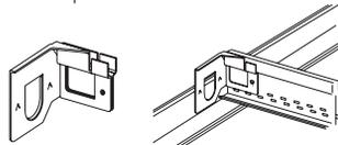
**Attache de joint sismique – Té principal** – Permet de diviser le plafond à la jonction du té principal de manière à respecter l'exigence du Code international du bâtiment voulant que les plafonds de plus de 2 500 pi<sup>2</sup> soit dotés de joints de séparation sismiques. Le manchon de rallonge ER4 sert à couvrir l'écart de 3/4 po.
