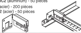
**BERC – Attache de retenue d'extrémité de té** – Pour fixer l'âme du té principal ou du té croisé à la moulure murale sans rivets pop visibles.
