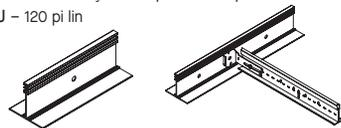
**STAC – Attache d'adaptateur de té simple** - utilisée pour créer des connexions hors module entre le té principal et les tés croisés conformes au code pour installations sismiques et non sismiques de catégorie C, D, E, F.
