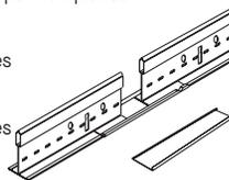
**AXSJ – Raccordement couissant Axiom<sup>MD</sup>** – sert à raccorder deux systèmes de plafond acoustique dans des installations sismiques D, E et F. Peut également servir à raccorder deux systèmes de plafond différents. Trous de fil de suspension tous les 6 po en commençant à 3 po de chaque extrémité.
