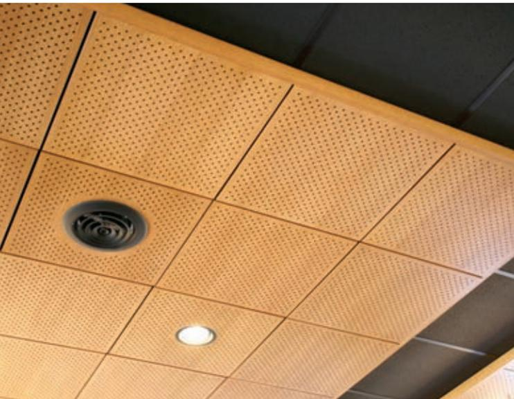
Le Panneau plat série 4 (SS4) est un système de panneaux de plafond avec une suspension disposant d'un support en bois à suspendre sous la suspension Armstrong<sup>MD</sup> Prelude<sup>MD</sup> XL<sup>MD</sup> pour créer des retraits de 3/8 po entre les panneaux. Les panneaux intègrent un système de soulèvement et de déplacement pour l'accessibilité.
