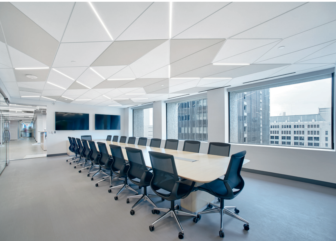
▲ Panneaux de plafond Calla Formes avec système de suspension Suprafine XM de 9/16 po
