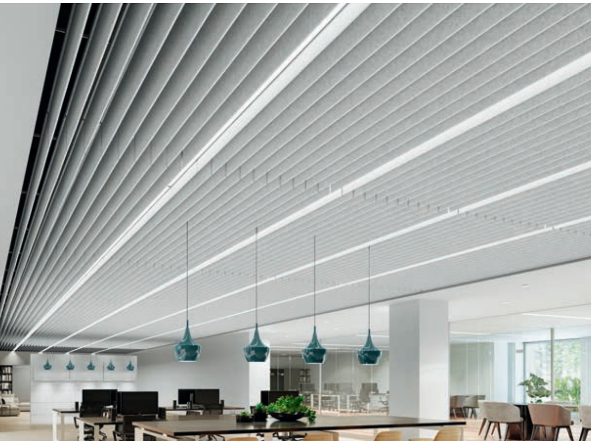
▲ Lames FeltWorks MD – VarAffix MC de 10 x 120 po fini Fond rocheux (FBR) installées directement sur une suspension de 15/16 po
