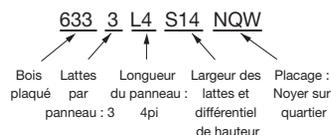
♦ Lors de la spécification ou de la commande, veuillez indiquer la longueur de latte (4, 6, ou 8) et le suffixe de finition (p. ex. 6333L 4 S14 N Q W – 3 lattes, 3/4 × 48 × 2 1/2 po avec placage de Noyer sur quartier).
