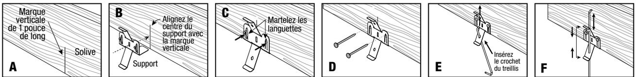
**IMPORTANT** : Ne coupez pas les crochets QuickHang<sup>MC</sup>. Si la longueur des crochets doit être plus courte à cause d'une obstruction, la partie supérieure peut être pliée manuellement ou à l'aide de pinces.
